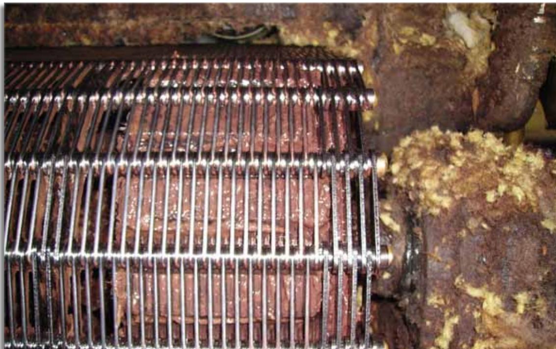
850,2/LaK pour fabrication de laine de verre ou laine de roche 850,2/LaK in production process for mineral wool
