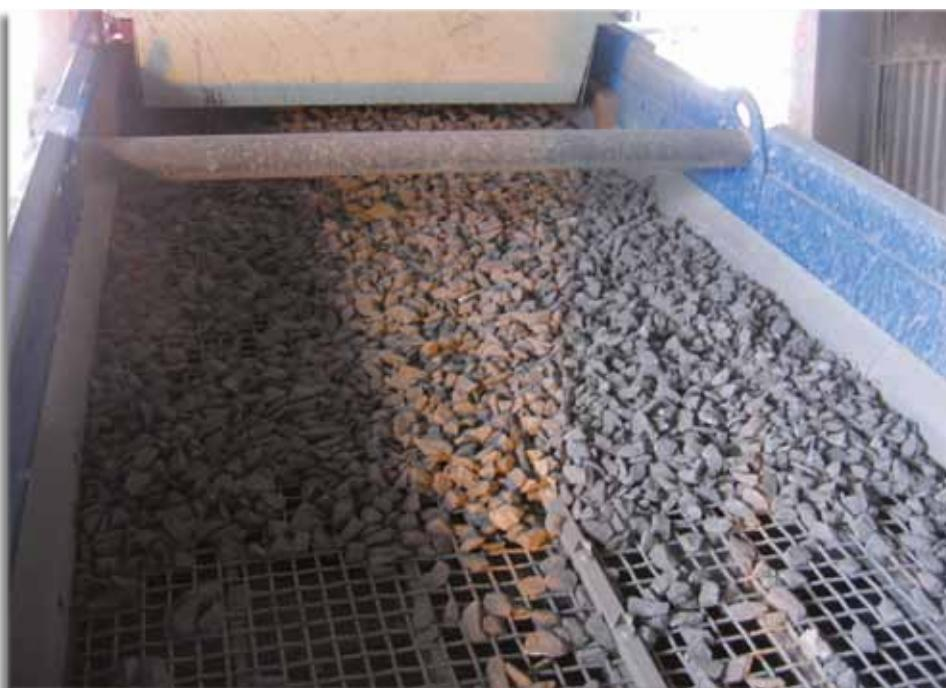
Die dynamischen Parameter der DELTA 2 Siebmaschine sind so ausgelegt, das dem Wurf eines Materialpartikels genau zwei Schwingungen (Kreisbewegungen) der Siebmaschine entsprechen.
