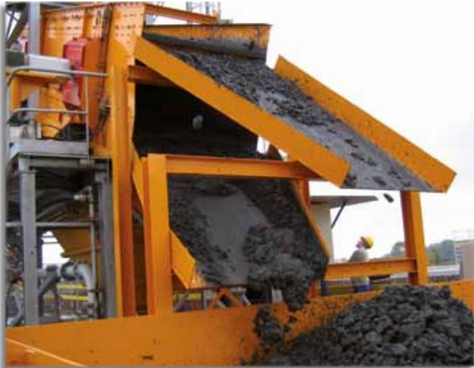
Absiebung von Hafen- und Baggerschlamm bei Trennschnitten zwischen 6 und 25 mm.
