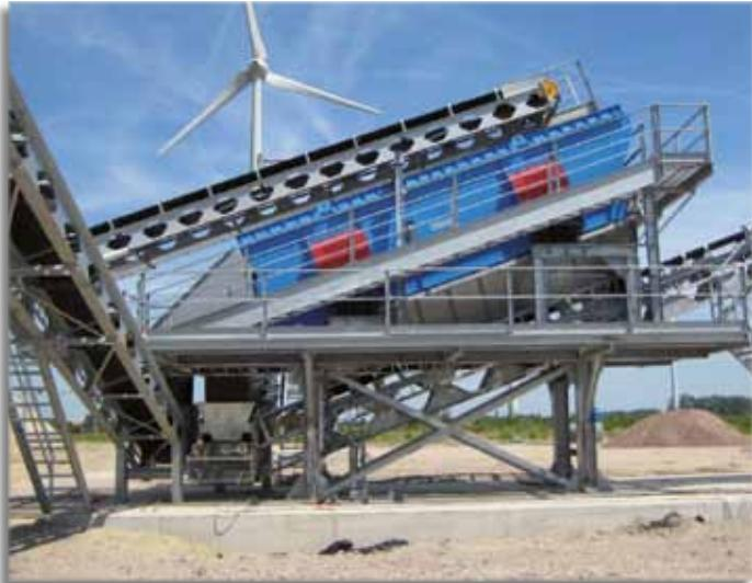
Absiebung von feuchtem Meersand bei Trennschnitten zwischen 2 und 12 mm.
