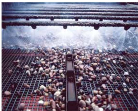
**HEIN, LEHMANN - Zuckerzentrifugen** arbeiten kontinuierlich. Sie können den Zucker je nach Ausstattung in fester Form oder gelöst als Kläre austragen. Ein Modell mit Zwei-Stufenkorb ermöglicht das Vor- und Nachschleudern in einer Zentrifuge.
