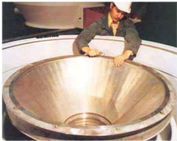
**Les centrifugeuses HEIN LEHMANN** sont des machines qui travaillent en continu et permettent d'obtenir du sucre en solution ou du sucre sec selon le cas. Une exécution avec un panier à deux étages offre la possibilité d'effectuer un double essorage en une seule étape.
