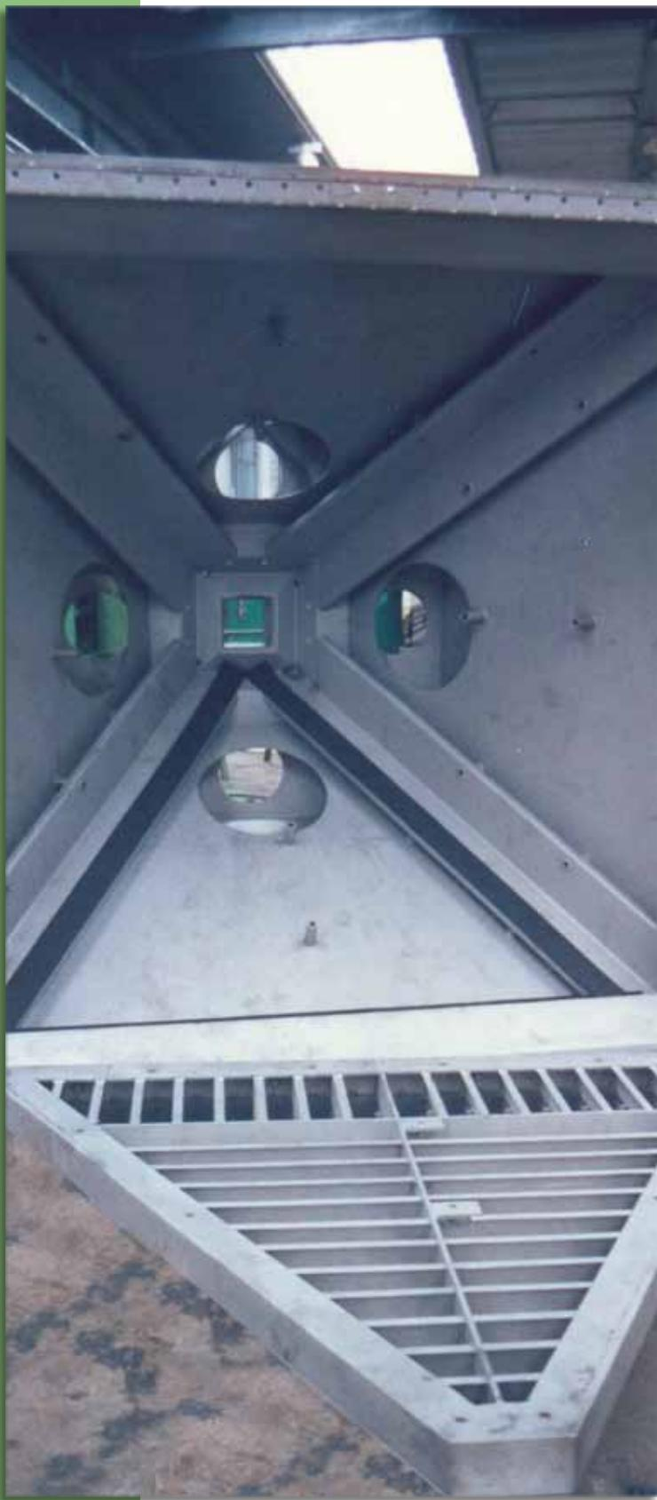
Zum Einbau in eine Silospitze vorbereitetes CONIDUR® - Belüftungselement
