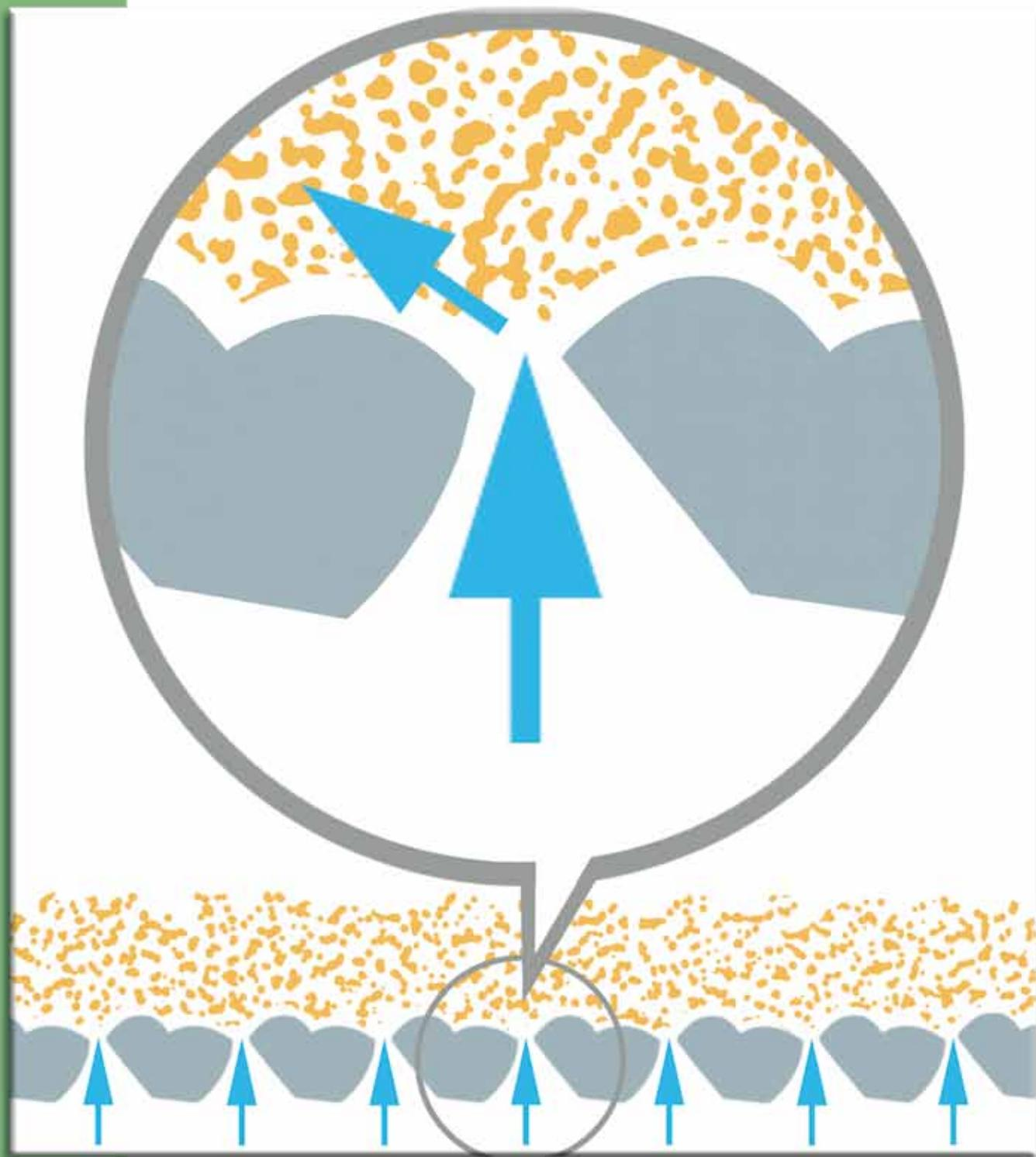
Die horizontale Luftrichtungskomponente ermöglicht die Produktförderung in eine Richtung und unterstützt dabei den Entleerungsvorgang.
