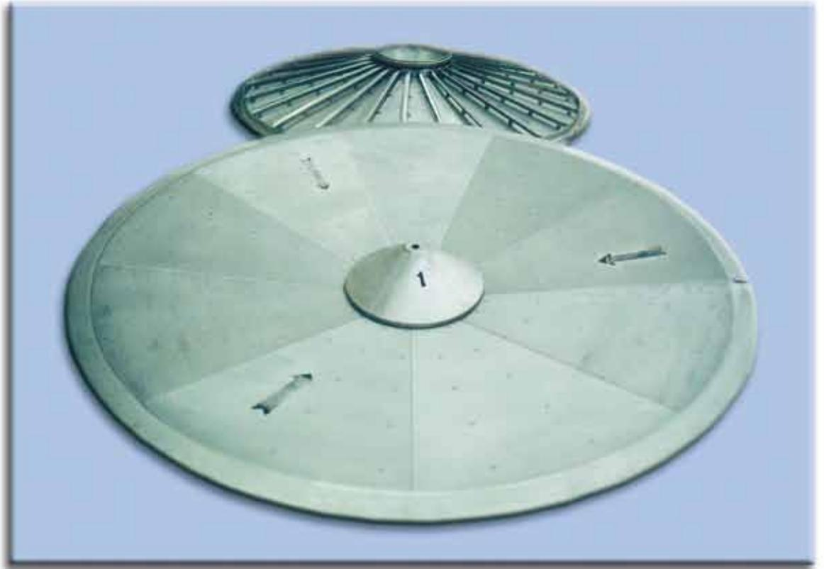
Konischer CONIDUR® Boden mit zentrischer Luftführung zum Produktaustrag (Produktseite, oben) in selbsttragender Ausführung, mit untergenieteten Befestigungsstreben (Anströmseite, unten).
