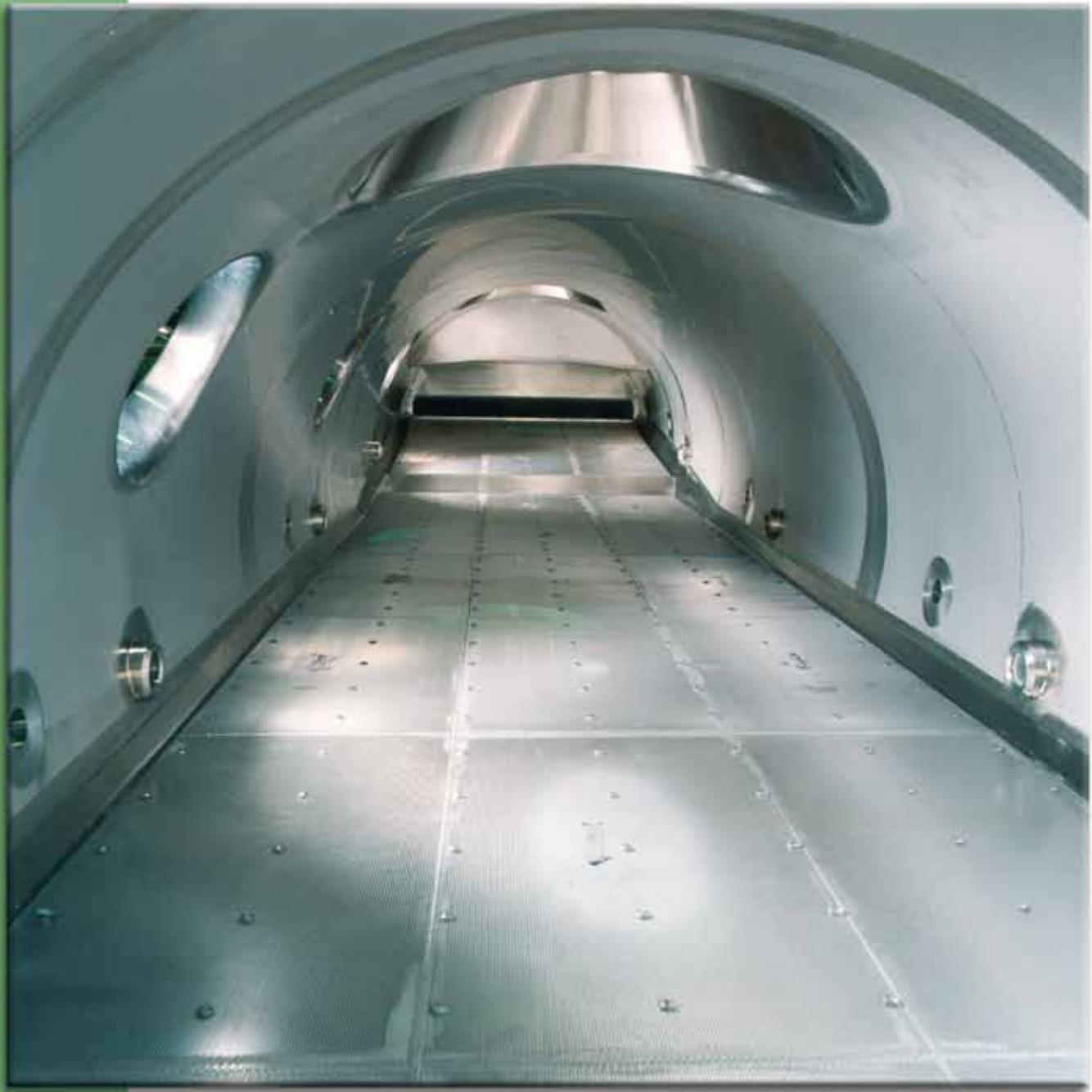
CONIDUR®-Feinlochblech als Anströmboden in einer Fließbettanlage.
